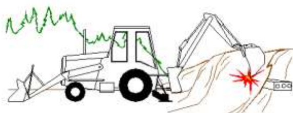
Figura 1 – Contatto con linee elettriche interrata
