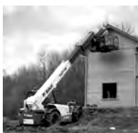
esempio di piattaforma con meccanismo di sollevamento a braccio telescopico (fonte BOBCAT ITALIA)
